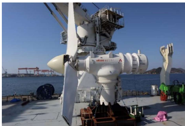
図 2-18. 長崎県五島市における 500kW 潮流発電機 17
