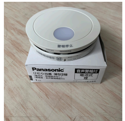
義務化されている火災警報器
